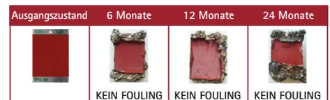
Test Ergebnisse von statischen Tests, die im Indischen Ozean durchgeführt wurden
